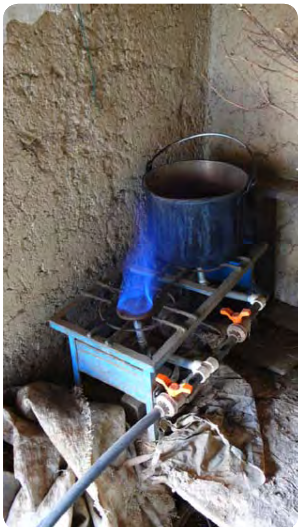
Figura 2: Cocina metálica adaptada para funcionar con biogás.
