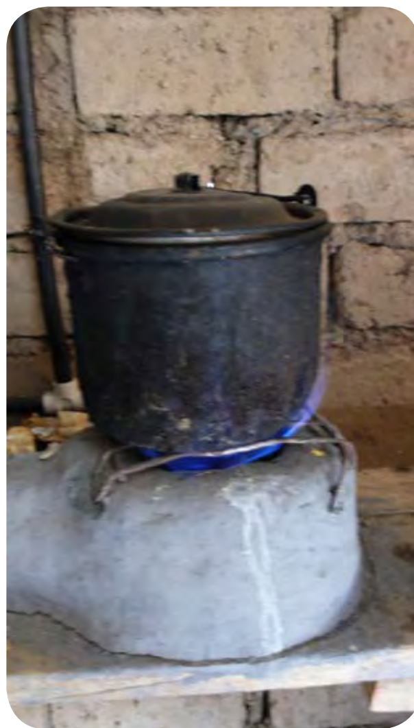
Figura 8: Cocina artesanal de biogás hecha con tubería de hierro de ½” y la estructura en barro. Consume, una media, 140 litros por hora.
