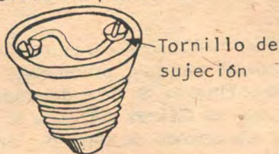
Reparación de un fusible
